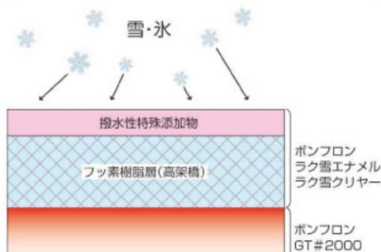
塗膜表面に浮いた撥水性特殊添加物が雪・氷をはじきさらに、フッ素樹脂を高架橋にすることによって雪を落とす効果を向上させます。
